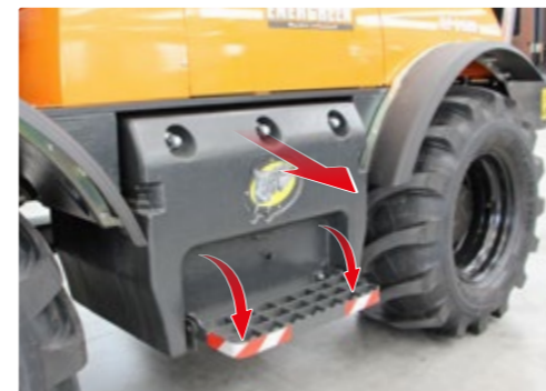
Hydraulisch ausfahrbares Kontergewicht mit Trittstufe
