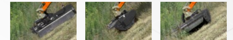
ROTATOR UNIT HYDRAULISCHER DREHKRANZ FÜR DIE 180°-DREHUNG DER ANBAUGERÄTE
