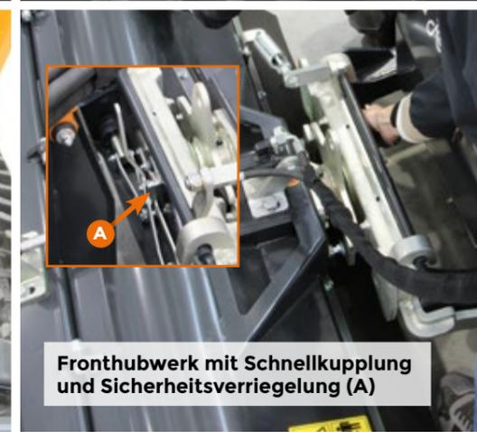
Fronthubwerk mit Schnellkupplung und Sicherheitsverriegelung (A)
