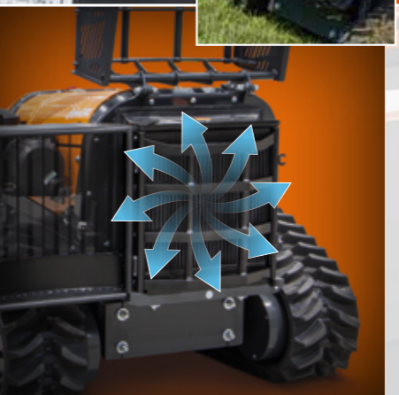
FREXXAIRE® SELBSTREINIGENDER UMKEHRLÜFTER
