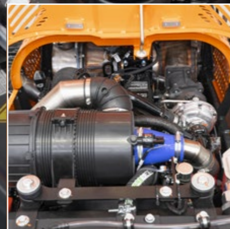
60-PS-MOTOR VON YANMAR, STUFE V
