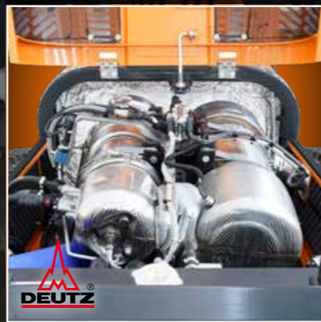
DEUTZ-MOTOR 100 PS, ABGASSTUFE V
