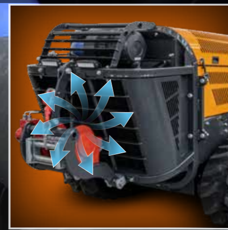
FREXXAIRE® SELBSTREINIGENDER UMKEHRLÜFTER
