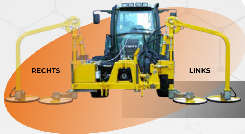
ARBEITEN AUF RECHTER ODER LINKER POSITION
