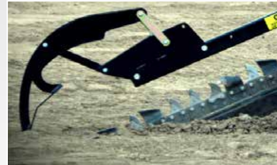
Stahlkratzer für die Baugrubenreinigung
